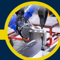
Toksas integroituna robottisärmäyssoluun Elekmerk
